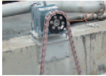
Napęd na przegubowym wsporniku silnika. Zabezpieczenie przed przeciążeniem za pomocą watomierza
