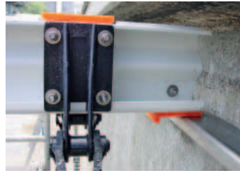
Ruch powrotny na szynach ze stali szlachetnej dzięki poliuretanowym (PU) trzewikom ślizgowym
